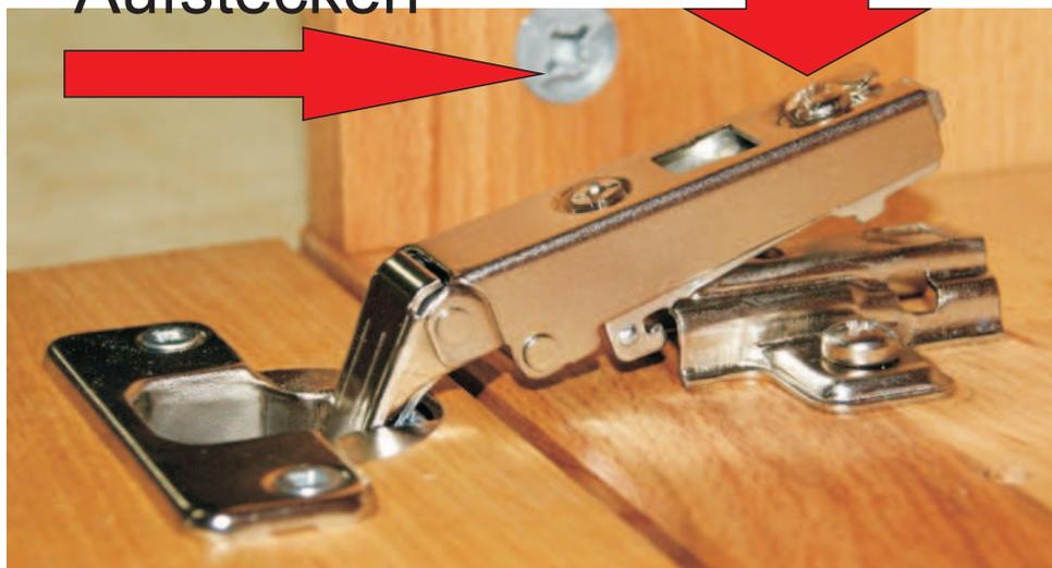
3. Das Topfband wird auf die Montageplatte geschoben und festgedrückt. Das Band rastet dann in die Montageplatte ein.
